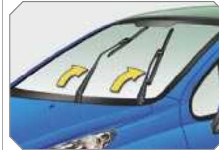
Jede Betätigung des Scheibenwischerschalters binnen einer Minute nach Ausschalten der Zündung bewirkt, dass die Scheibenwischer in die Mitte der Windschutzscheibe gestellt werden.
