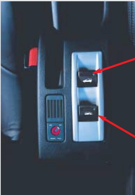
Betätigungsknopf (sequentiell) zur vollautomatischen Öffnung des Daches
